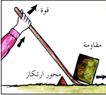
(عتلة تستخدم في إزاحة جسم من مكانه) شكل ( ٢ )
